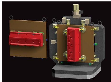
Accesorio: cara 1 "Marco" luminaria con placas lámpara reemplazable
