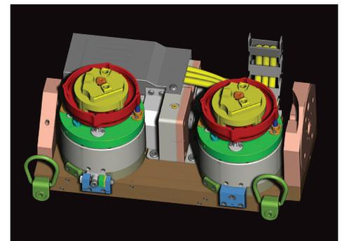
Accesorio: accesorio de 5 ejes trunion con el motor servo integral
